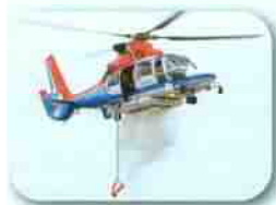
消火用タンク (ファイヤーアタッカー)
