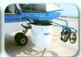
ヘリコプター テレビ電送システム (可視 / 赤外線カメラ装備)
