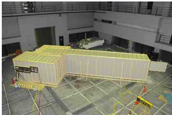
写真5 燃烧実験建物（1階部分を再現）
