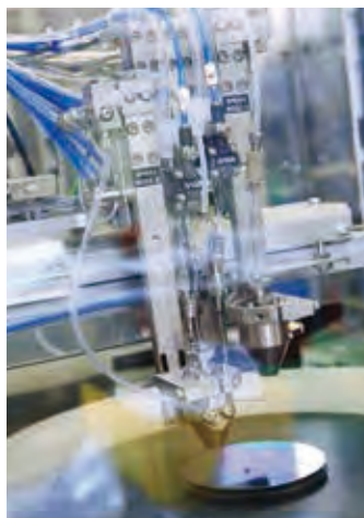
■スプレーコータの塗布作業
