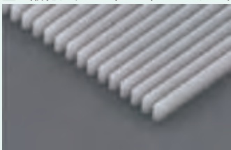
■二酸化シリコン (SiO 2 )のエッチング例
