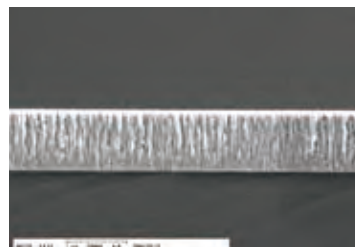
■二酸化シリコンSiO 2 のエッチング例
