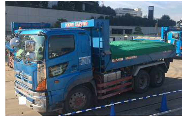
参考写真3: 汚染土壌運搬時の飛散防止(例)
