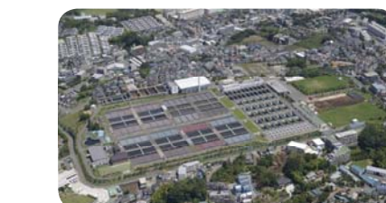
潮見台配水池 再構築計画により平成23年度末に浄水場としての機能を廃止し、配水施設(配水池・送水ポンプなど)となりました。配水池は、昭和46年3月完成、有効容量は約2.8万m 3 です。また、企業団西長沢浄水場と併設しています。
