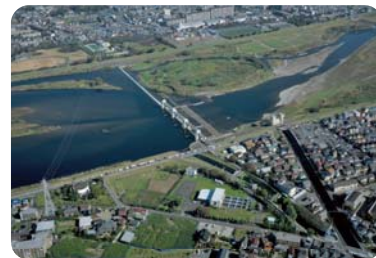
稲田取水所 上河原堰提により二ヶ領用水に分水された多摩川の河川水を稲田取水所で取水しています。
