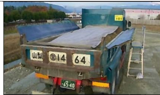
写真① 荷台への防じんシートの設置
