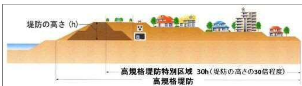
高規格堤防の概略図（国土交通省京浜河川事務所HPより）
