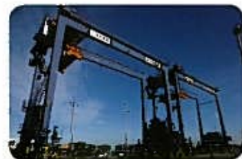
トランスファークレーン Transfer Crane
