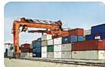
トランスファークレーン Transfer Crane
