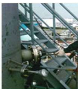
工場の立入によるばい煙測定
