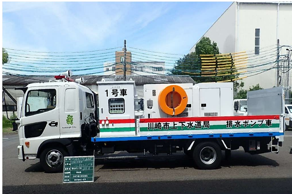
排水ポンプ車 (30m 3 /min・8t車積載型)
