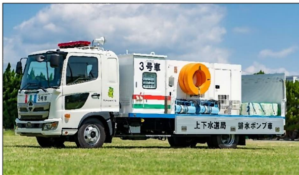
排水ポンプ車
