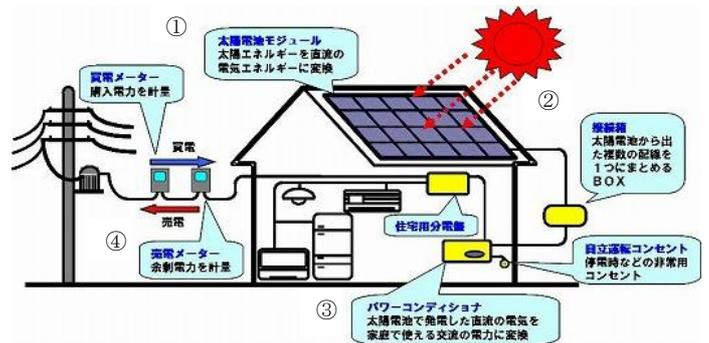
図2 住宅用太陽光発電システム
