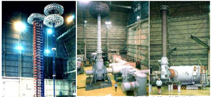
左からインパルス電圧発生器、試験用変圧器、密閉型直流発生器
