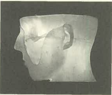
CTスキャナーの断層データを立体データへと変換して製作した光造形モデル。診断、治療、そして切開手術をおこなう前のシミュレーションが可能になりました。
