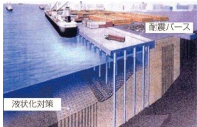
東扇島9号岸壁の耐震改修
