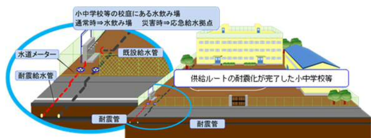
開設不要な応急給水拠点の設置
