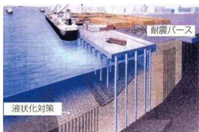
東扇島9号岸壁の耐震改修
