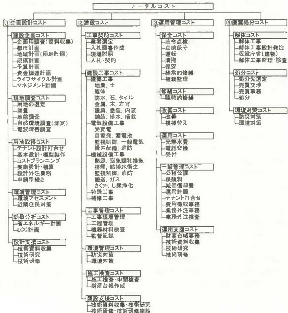
図3 建築物のLCC項目の体系化
