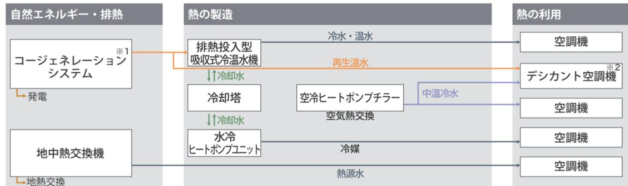
※1 コージェネレーションシステム：原動機等が発電する電力とその排熱による熱を同時に供給することができるシステム
