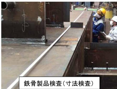
鉄骨製品検査(寸法検査)
