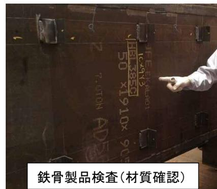
鉄骨製品検査(材質確認)
