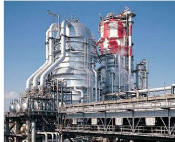
原油を沸点の差を利用して石油ガス、ナフサ、灯油等に分ける装置
