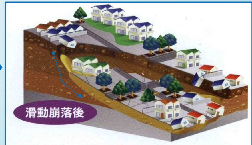
大規模盛土造成地の滑動崩落を防止するための事業
