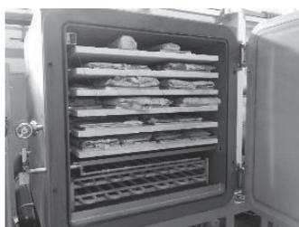
真空凍結乾燥機による乾燥作業
