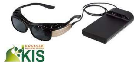
視力に依存しない網膜投影ディスプレイ 「RETISSA Display II」
