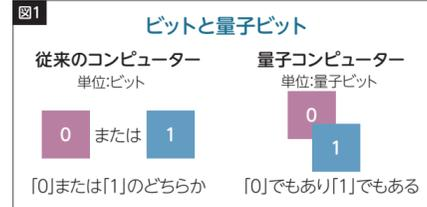
従来のコンピューターと量子コンピューターでは、同時に扱える情報の質や量が違いがあります。例えば1ビットと1量子ビットで比べると、1ビットなら「0」か「1」のどちらか1つの情報を扱うのに対し、1量子ビットでは「0」と「1」の両方を同時に扱うことができます。2ビットなら「00」「01」「10」「11」の4つのうちのどれか1つ、2量子ビットなら「00」「01」「10」「11」の4つを同時に扱えます。**ビット数が増えると、「ビット」と「量子ビット」の情報量の違いは決定的になり、例えば50量子ビットなら1,000兆以上の膨大な情報を同時に扱うことができます(図2)。**
