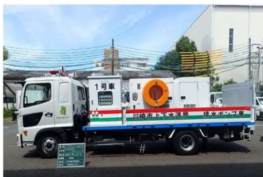
排水ポンプ車の導入
