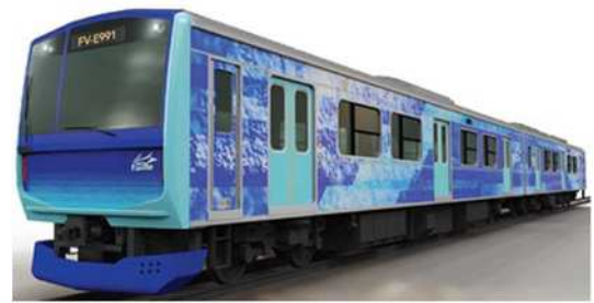
ハイブリッド車両（※）試験車両のイメージ （※）水素をエネルギー源とした燃料電池と蓄電池の組み合わせで走行する電車（JR 東日本の実証試験で使用）
