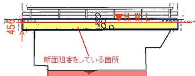
図：二ヶ領本川断面阻害イメージ（例：朝日橋断面図）
