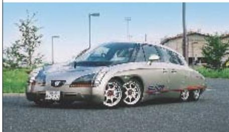
慶應義塾大学K<sup>2</sup>タウンキャンパスで開発された電気自動車。100円の電気代で約100キロメートルの走行が可能。
