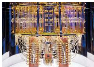
IBM Quantum System Oneの内部は量子状態維持のため絶対零度に近い極低温で冷却されている
