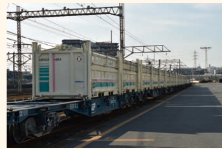
一般廃棄物を鉄道「クリーンかわさき号」で輸送する専用のコンテナ
