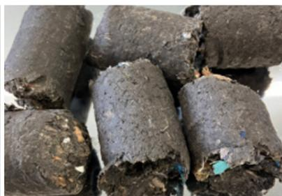
精錬工程では、溶けた鉄から除去する不純物が酸素とともに膨張・発泡(フォーミング)して炉の外へあふれる恐れがあるため、この現象を抑制する必要がある。また、電炉では溶けた鉄スクラップを還元するために使う石炭やコークスの代替品として、加炭材が有効となる。
