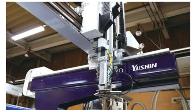
導入した新型取出装置
