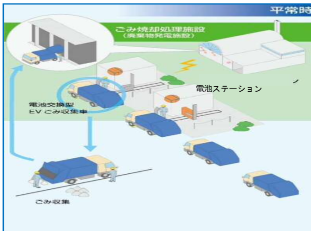
廃棄物発電を活用した「ゼロ・エミッションシステム」概念図
