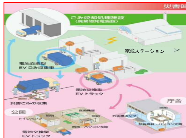
廃棄物発電を活用した「ゼロ・エミッションシステム」概念図
