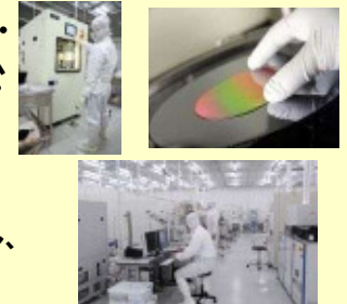
NANOBIC 大型クリーンルーム(約750m 2 ) (クリーンルーム:ナノレベルの精密な加工で必要不可欠な、ホコリやゴミなどの浮遊物質がないクリーンな状態を保った空間)
