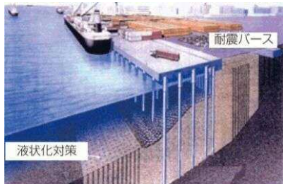
東扇島9号岸壁の耐震改修
