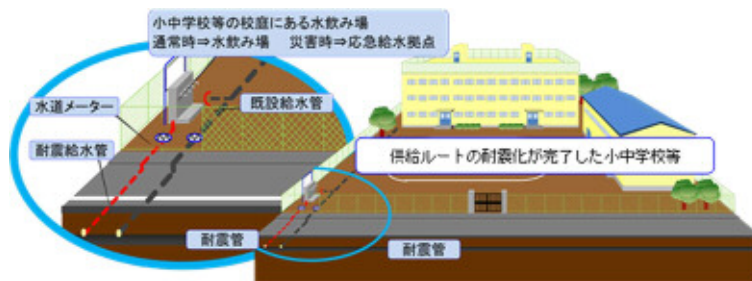
開設不要な応急給水拠点の設置
