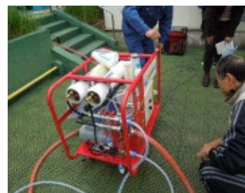
非常用浄水装置
