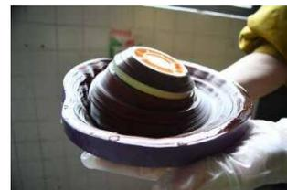
(写真2 変形したフィルム)
