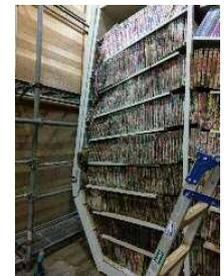
（写真2 水で膨張した雑誌で壊れた棚）
