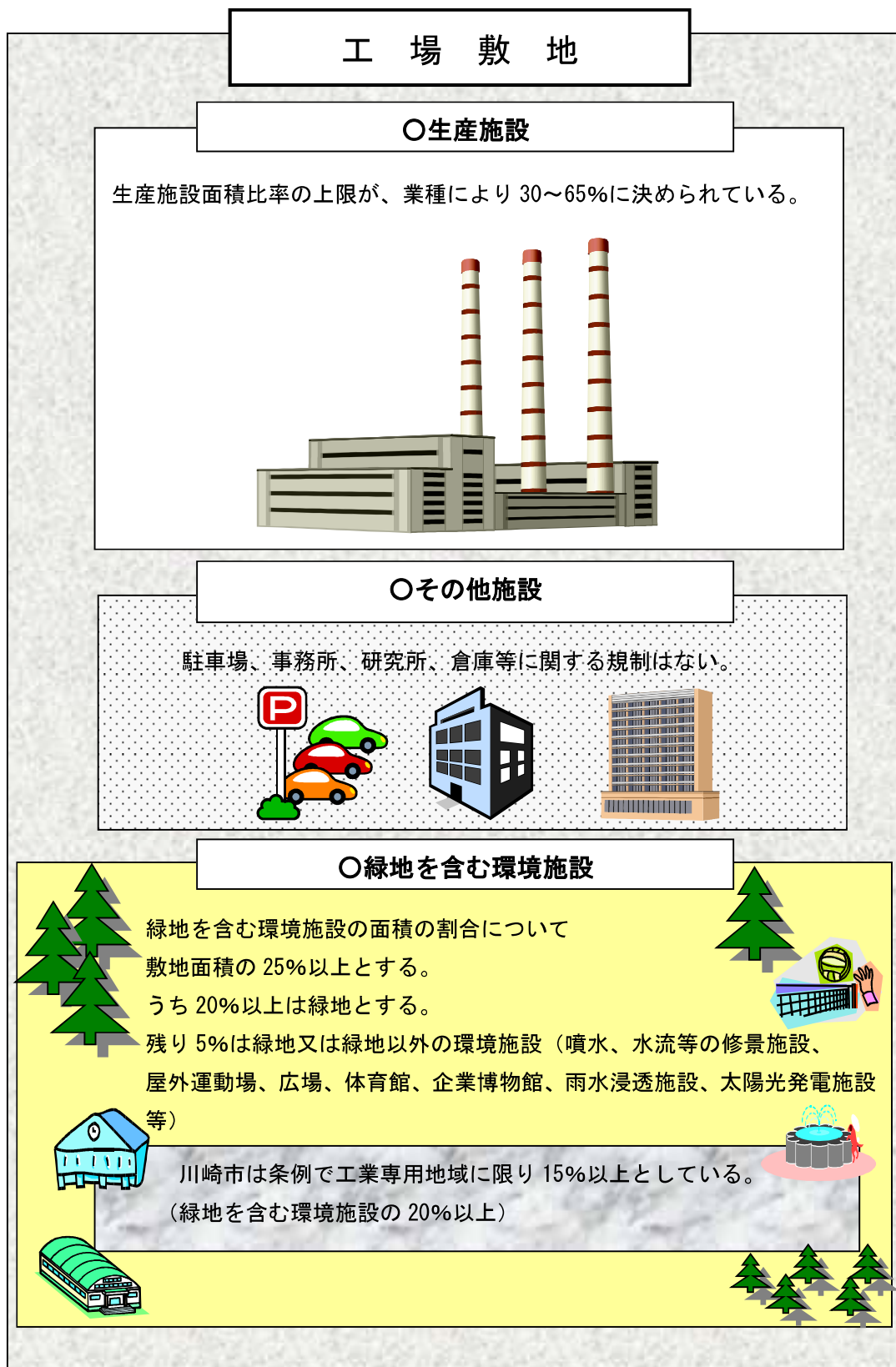
図表2 工場立地に関する準則における工場敷地利用の考え方
