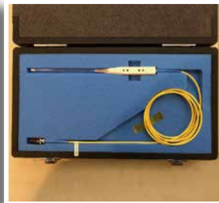
プリズム付き光電磁界プローブ
