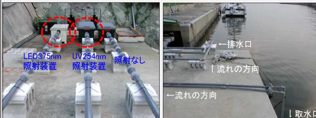
小型流水モデル水路の設置状況 (LED375nm、UV殺菌灯254nm、照射なし)
