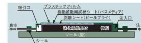
図1 VaRTM工法の模式図 成形型の上に積層した強化繊維基材（ガラス繊維やカーボン繊維の織物など）を、プラスチックフィルム等で封入して真空吸引した後に、液状樹脂を注入・含浸して硬化させる。
