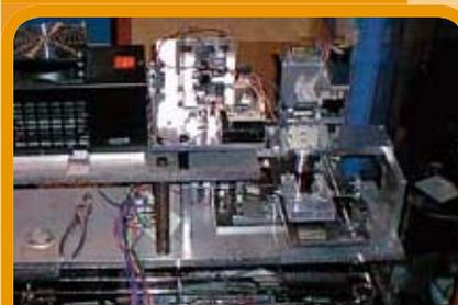
顕微鏡のレンズを使って恒星基板にレーザーをあてて穴をあけるスーパーマイクロプロッタ。
