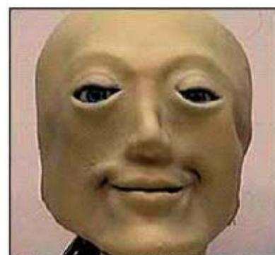
言葉に反応して表情を変えるロボット
