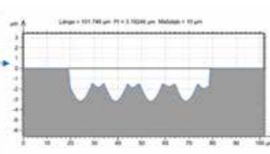
マイクロアレイレンズの加工例。最大深さ3.19μm、ピクセルサイズ200nm。使用レジスト材料: AZ4562
