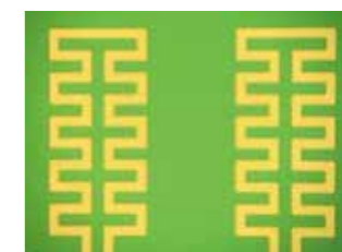
■図2 NiCr電極の拡大図（線幅は30μm）
