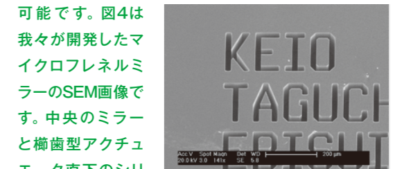
図1 シリコン深掘装置による微細な溝構造
