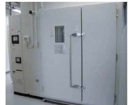
恒温恒湿槽 (大型：サイズW2,850×D2,100×H3,200mm)
