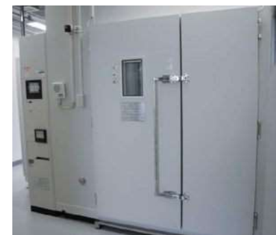
恒温恒湿槽 (大型：サイズW2,850×D2,100×H3,200mm)
