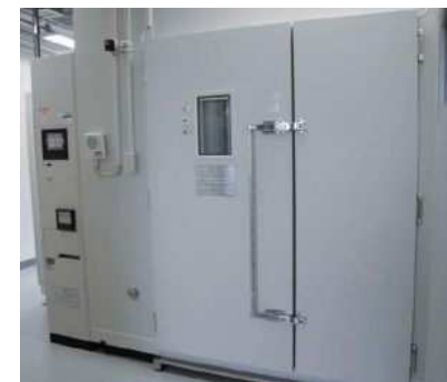
恒温恒湿槽 (大型：サイズW2,850×D2,100×H3,200mm)
