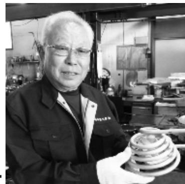
自分で開発した機械「アングルベンダー」で、パイプや形鋼など様々な鋼材を立体的に曲げができる技術を保持している。どうやって曲げるのか想像しがたい形のものを、2次元だけでなく3次元形状にも加工して、多種少量生産に対応できる技術力を構築している。「これはできません」とは絶対言わないことが信条。
