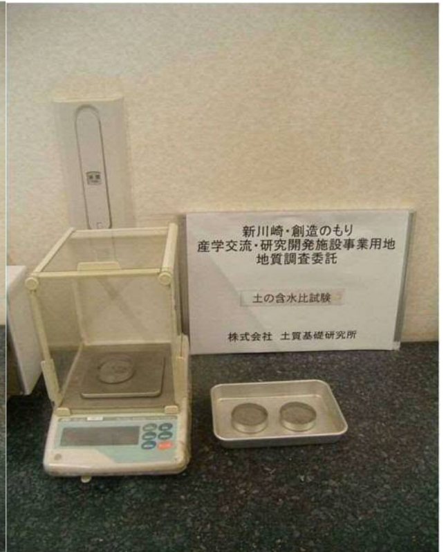
土の含水比試験
