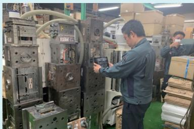
タブレット端末で金型のQRコードを読み込む
