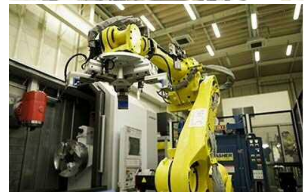
旋盤加工とマシニング加工を行う複合加工機と組み合わせたロボット（写真上下ともに）
